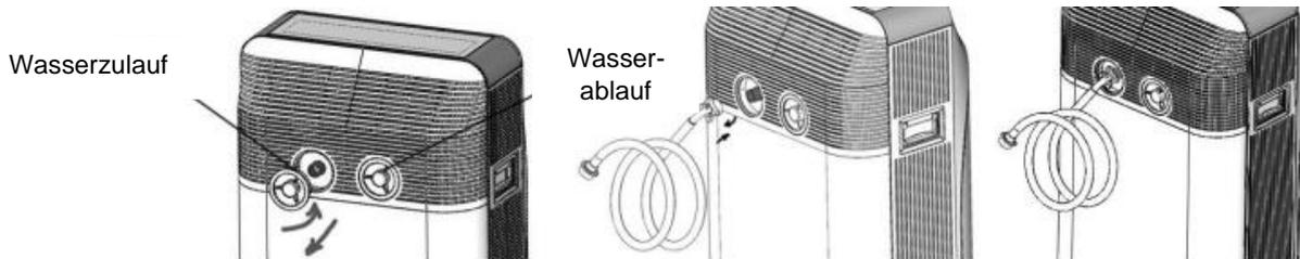
Nachdem der Wasserschlauch mit dem Klimagerät verbunden ist, gibt es 5 Möglichkeiten den Wasserschlauch mit dem Wasserhahn zu verbinden. Hierbei muss darauf geachtet werden, dass die Verbindung dicht ist. Die 3 unterschiedlichen Schlauchverbinder sind für jeweils unterschiedliche Wasserhähne gedacht.
